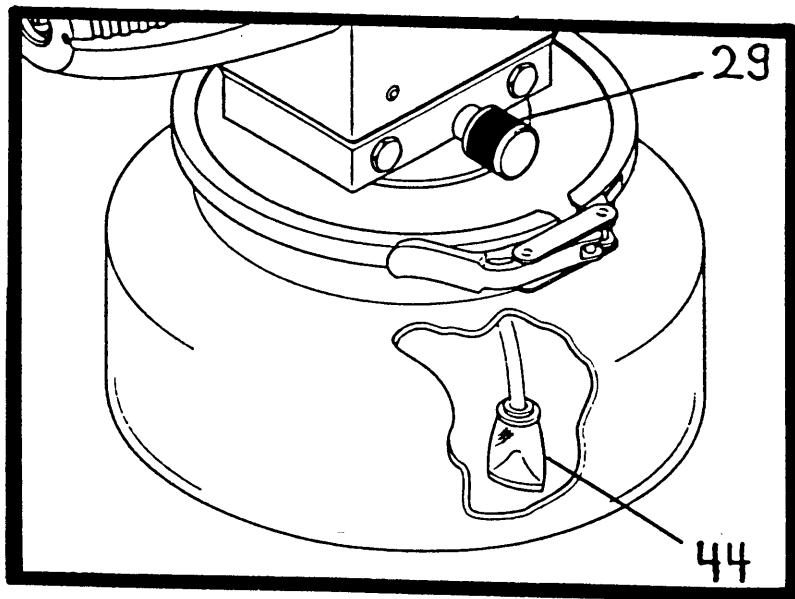
**След приключване на работа, налейте топла вода в резервоара и я издухайте за да промиете системата от остатъчни количества на препарата!**
